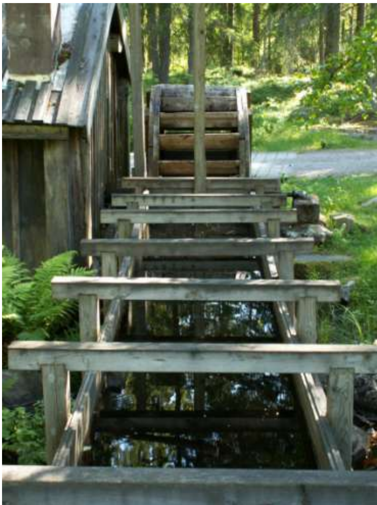
I Karmansbo pågår försök att fåska lancashirejärn och vattenhjulet driver hammaren vid hopslagningen. Foto Ida Dicksson
