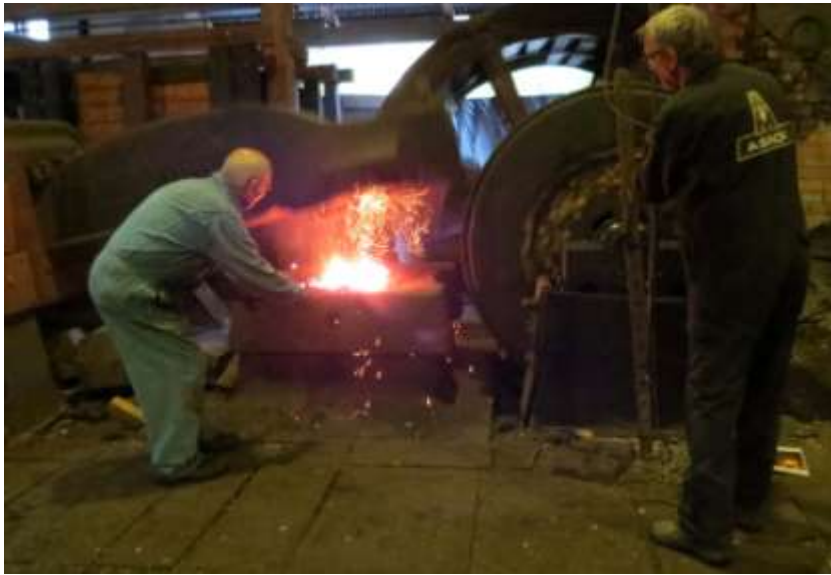
I Karmansbo pågår försök att fåska lancashirejärn och vattenhjulet driver hammaren vid hopslagningen. Foto Ida Dicksson
